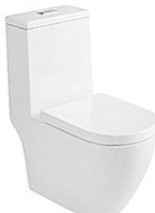
BX-1612 自由阻連體坐便器 尺寸: 690x360x820毫米 橫排污: 排污口中心離地180毫米 地排污: 排污口中心離地250毫米 配: UF柔壓板 Universal Trap One-piece water closet Size: 690x360x820mm P-trap: 180mm Roughing-in S-trap: 250mm Roughing-in Including: UF thermostetting soft-close seat cover
