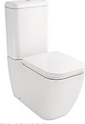
IM-10100C 自由組分體坐便器 尺寸: 645x357x840 毫米 橫排污: 排污口中心離地 185 毫米 地排污: 排污口中心離地 220 毫米 配: UF 柔壓板 Universal Trap Two-piece Water Closet Size: 645x357x840mm P-trap: 185mm Roughing-in S-trap: 220mm Roughing-in Including: UF thermosetting soft close seat cover
