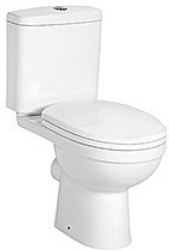
IM-61076C 直衝式分體坐便器 尺寸: 615x345x760 毫米 橫排污: 排污口中心離地 185 毫米 配: PP/UF柔壓板 Washdown Two-Piece Water Closet Size: 615x345x760mm P-trap: 185mm Roughing-in Including: PP/UF thermostetting soft close seat cover
