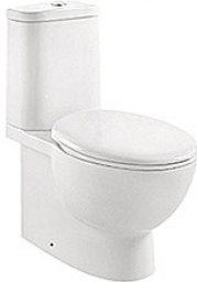
IM-61092C 自由組分體坐便器 尺寸: 650x375x790 毫米 橫排污: 排污口中心離地 185 毫米 地排污: 排污口中心離地 220 毫米 配: PP/UF 柔壓板 Universal Trap Two-Piece Water Closet Size: 650x375x790mm P-trap: 185mm roughing-in S-trap: 220mm roughing-in Including: PP/UF thermosetting soft-close seat cover
