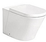
IM-71088 坐地廁 尺寸: 520x360x350毫米 橫排污: 排污口中心離地 185毫米 配: UF柔壓板 Back to wall W.C Size: 520x360x350mm P-trap: 185mm roughing-in Including: UF thermostetting soft-close seat cover
