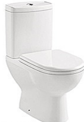
IM-41010 自由組分體坐便器 尺寸: 610x345x780 毫米 橫排污: 排污口中心離地 185 毫米 地排污: 排污口中心離地 220 毫米 配: PP/UF 柔壓板 Universal Trap Two-Piece Water Closet Size: 610x345x780mm P-trap: 185mm roughing-in S-trap: 220mm roughing-in Including: PP/UF thermosetting soft-close seat cover
