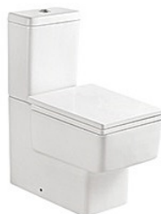
BD-6868-1 直衝式分體坐便器 尺寸: 670x355x760 毫米 橫排污: 排污口中心離地 185 毫米 配: UF柔壓扇板 Washdown Two-piece Water Closet Size: 670x355x760mm P-trap: 185mm Roughing-in Including: UF thermostetting soft-close seat cover
