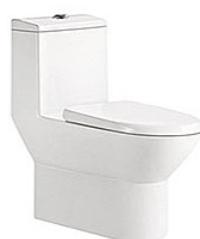
BX-1796 虹吸式連體坐便器 尺寸: 680x365x710毫米 地排污: 排污口中心離地300、400毫米 配: PP/UF柔壓板 Siphonic One-piece water closet Size: 680x365x710mm S-trap: 300、400mm Roughing-in Including: PP/UF thermostetting soft-close seat cover
