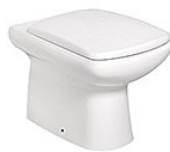
IM-1064B 坐地廁 尺寸: 580x380x400 毫米 橫排污: 排污口中心離地 185 毫米 配: UF 柔壓板 Back to wall W.C Size: 580x380x400mm P-trap:185mm roughing-in Including:UF thermostetting soft-close seat cover
