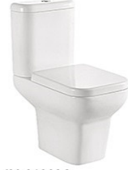
IM-61068C 自由組分體坐便器 尺寸: 620x355x800 毫米 橫排污: 排污口中心離地 185 毫米 地排污: 排污口中心離地 220 毫米 配: UF 柔壓板 Universal Trap Two-piece Water Closet Size: 620x355x800mm P-trap: 185mm roughing-in S-trap: 220mm roughing-in Including: UF thermosetting soft-close seat cover
