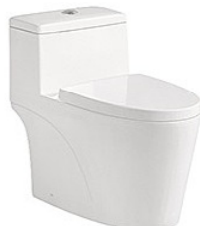
BX-1668 虹吸式連體坐便器 尺寸: 700x420x650毫米 地排污: 排污口中心離地300、400毫米 配: PP/UF柔壓板 Siphonic One-piece water closet Size: 700x420x650mm S-trap: 300、400mm Roughing-in Including: PP/UF thermostetting soft-close seat cover
