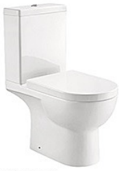
IM-81089C 自由阻座廁 尺寸: 650x355x790毫米 橫排污: 排污口中心離地185毫米 地排污: 排污口中心離地210毫米 配: UF柔壓板 Universal Trap Two-piece Water Closet Size: 650x355x790mm P-trap: 185mm Roughing-in S-trap: 210mm Roughing-in Including: UF thermostetting soft-close Seat cover
