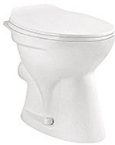
2310 坐地廁 尺寸: 530x350x400 毫米 橫排污: 排污口中心離地 185 毫米 不包圍板 Back to wall W.C Size: 530x350x400mm P-trap: 185mm roughing-in Excluding seat cover
