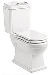
SD-2043 復古直衝式分體坐便器 尺寸: 690x360x850毫米 橫排污: 排污口中心離地 185毫米 配: 白色木磨板 Washdown Two-Piece Water Closet Size: 690x360x850 mm P-trap: 185mm Roughing-in Including: Wooden white seat cover
