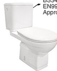
BS3402:1969 EN997:2003 Approval 2850D 直衝式微殘分體坐便器 尺寸: 690x390x740 毫米 橫排污: 排污口中心離地 105、185 毫米 地排污: 排污口中心離地 220、300 毫米 配: PP扇板 /UF柔壓板 Disable washdown two-piece Water Closet Size: 690x390x740mm P-trap: 105、185mm roughing-in S-trap: 220、300mm Roughing-in Including: PP seat cover/UF thermostetting soft-close seat cover
