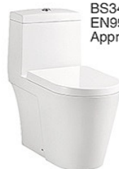
2850 直衝式分體坐便器 尺寸: 690x390x740 毫米 橫排污: 排污口中心離地 185、105 毫米 地排污: 排污口中心離地 200、300 毫米 配: PP扇板 /UF柔壓板 Washdown Two-piece Water Closet Size: 690x390x740mm P-trap: 185、105mm Roughing-in S-trap: 200、300mm Roughing-in Including: PP seat cover/UF thermostetting soft-close seat cover
