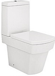
IM-41060C 自由組分體坐便器 尺寸: 630x360x810 毫米 橫排污: 排污口中心離地 185 毫米 地排污: 排污口中心離地 100 毫米 配: UF 柔壓板 Universal Trap Two-Piece Water Closet Size: 630x360x810mm P-trap: 185mm roughing-in S-trap: 100mm roughing-in Including: UF thermosetting soft-close seat cover
