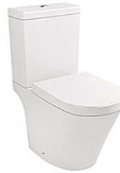
IM-81088C 直衝分體坐便器 尺寸: 630x360x810 毫米 橫排污: 排污口中心離地 185 毫米 配: UF 柔壓板 Washdown Two-Piece Water Closet Size: 630x360x810mm P-trap: 185mm roughing-in Including: UF thermosetting soft-close seat cover
