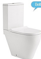
BM-4089 自由組分體坐便器 尺寸: 630x352x805 毫米 橫排污: 排污口中心離地 192 毫米 地排污: 排污口中心離地 210、260 毫米 配: UF 柔壓板 Universal Trap Two-piece Water Closet Size: 630x352x805mm P-trap: 192mm Roughing-in S-trap: 210、260mm Roughing-in Including: UF thermosetting soft-close seat cover
