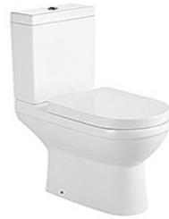
AB-4082 自由組分體坐便器 尺寸: 670x360x820 毫米 橫排污: 排污口中心離地 180 毫米 地排污: 排污口中心離地 300 毫米 配: UF 柔壓板 Universal Trap Two-piece Water Closet Size: 670x360x820mm P-trap: 180mm roughing-in S-trap: 300mm Roughing-in Including: UF thermosetting soft-close seat cover
