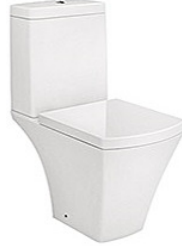
IM-41080C 自由組分體坐便器 尺寸: 630x360x810 毫米 橫排污: 排污口中心離地 185 毫米 地排污: 排污口中心離地 100 毫米 配: UF 柔壓板 Universal Trap Two-Piece Water Closet Size: 630x360x810mm P-trap: 185mm roughing-in S-trap: 100mm roughing-in Including: UF thermosetting soft-close seat cover
