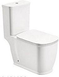
IM-10160C 自由組分體坐便器 尺寸: 680x360x830 毫米 橫排污: 排污口中心離地 185 毫米 地排污: 排污口中心離地 210 毫米 配: 超薄 UF 柔壓板 Universal Trap Two-piece Water Closet Size: 680x360x830mm P-trap: 185mm Roughing-in S-trap: 210mm Roughing-in Including: Slim UF thermosetting soft-close seat cover
