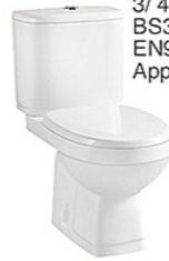
2850 直衝式分體坐便器 尺寸: 690x390x740 毫米 橫排污: 排污口中心離地 185、105 毫米 地排污: 排污口中心離地 200、300 毫米 配: PP扇板 /UF柔壓板 Washdown Two-piece Water Closet Size: 690x390x740mm P-trap: 185、105mm Roughing-in S-trap: 200、300mm Roughing-in Including: PP seat cover/UF thermostetting soft-close seat cover
