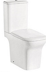
IM-688 自由組分體坐便器 尺寸: 650x360x840 毫米 橫排污: 排污口中心離地 185 毫米 地排污: 排污口中心離地 210 毫米 配: UF 柔壓板 Universal Trap Two-pieces water Closet Size: 650x360x840mm P-trap: 185mm Roughing-in S-trap: 210mm Roughing-in Including: UF thermosetting soft-close seat cover
