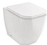
IM-6064B 坐地廁 尺寸: 520x350x400毫米 橫排污: 排污口中心離地 185毫米 配: UF柔壓板 Back to wall W.C Size: 520x350x400mm P-trap: 185mm roughing-in Including: UF thermostetting soft-close seat cover
