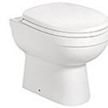
IM-1076B 坐地廁 尺寸: 500x345x390 毫米 橫排污: 排污口中心離地 185 毫米 配: PP/U 柔壓板 Back to wall W.C Size: 500x345x390mm P-trap:185mm roughing-in Including:PP/UF thermostetting Soft-close seat cover
