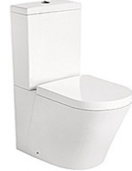
IM-91088 自由組分體坐便器 尺寸: 710x360x850 毫米 橫排污: 排污口中心離地 185 毫米 地排污: 排污口中心離地 220 毫米 配: UF 柔壓板 Universal Trap Two-Piece Water Closet Size: 710x360x850mm P-trap: 185mm roughing-in S-trap: 220mm roughing-in Including: UF thermosetting soft-close seat cover
