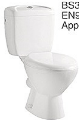
2860 直衝式分體坐便器 尺寸: 650x380x750 毫米 橫排污: 排污口中心離地 185 毫米 地排污: 排污口中心離地 200 毫米 配: PP扇板 Washdown Two-piece Water Closet Size: 650x380x750mm P-trap: 185mm Roughing-in S-trap: 200mm Roughing-in Including: PP seat cover
