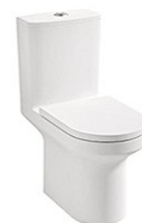
IM-81078 自由組分體坐便器 尺寸: 650x360x830 毫米 橫排污: 排污口中心離地 185 毫米 地排污: 排污口中心離地 210 毫米 配: UF 超薄柔壓板 Universal Trap Two-piece Water Closet Size: 650x360x830mm P-trap: 185mm Roughing-in S-trap: 210mm Roughing-in Including: Slim UF thermosetting soft-close seat cover
