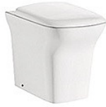
IM-688B 坐地廁 尺寸: 540x360x420毫米 橫排污: 排污口中心離地185毫米 配: UF柔壓板 Back to wall W.C Size: 540x360x420mm P-trap: 185mm Roughing-in Including: UF thermostetting soft-close seat cover
